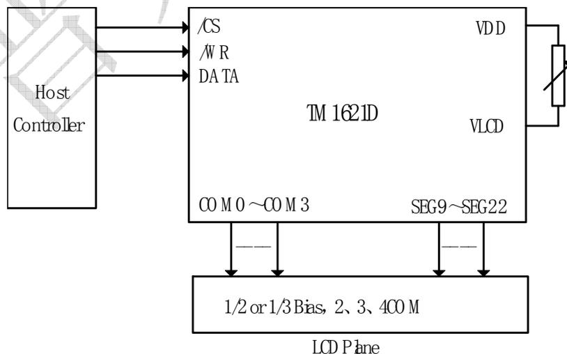
注意：1.VLCD 管脚的电压一定要小于 VDD 管脚的电压；
